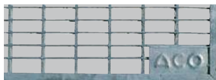
Rošt s okami, vzdialenosť ôk 30 x 10 mm, s možnosťou chôdze – zaťaženie do 1,5 kN, s možnosťou prejazdu do zaťaženia 9,0 kN
