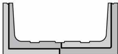
Káblový žľab s položeným krytom
