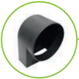
Pachový uzáver do vpustu DN 100, 150. Zabudovanie: Pachový uzáver vložíme z vnútra do odtokového otvoru a zvonku pripojíme kanalizačnú rúru.
