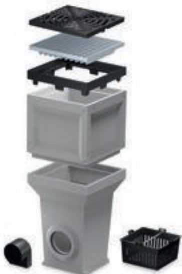
spot s liatinovým rámom s mriežkovým alebo liatinovým roštom do Tr. B vrátane pachového uzáveru a kalového koša s voliteľným nadstavcom
