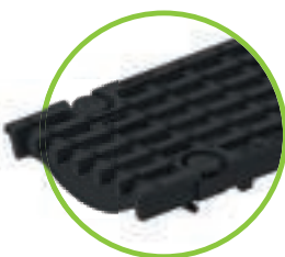
Liatinový rošt s pozdĺž. mriežkou. Veľkosť oka 27/13 Tr. E – SV-rýchlouzáver alebo na 4 skrutky, pre NW 100 až 200
