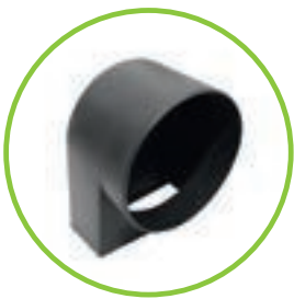
Pachový uzáver do vnútra vpustu DN 100 /150. Zabudovanie: Pachový uzáver vložíme zvnútra do odtokového otvoru a zvonku pripojíme kanalizačnú rúru.
