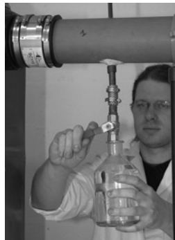
Základní zkouška: ověření výkonu odlučovače ropných látek.
