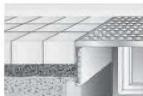
PVC nástavce MEAFLEX Výška v rozmezí 7,8-20 cm
