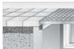
Ocelové nástavce MEAVECTOR pro navýšení 5 nebo 10 cm nad horní hranu světlíku.
