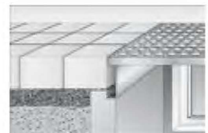
Ocelové nástavce MEAVECTOR pro navýšení 5 nebo 10 cm nad horní hranu světlíku.
